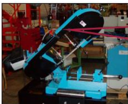
Фигура 21 – Отваряне на предпазния капак / развиване на винтовете
